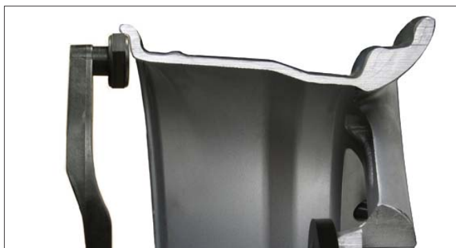
图 2 - 卡钩式平衡块位置
