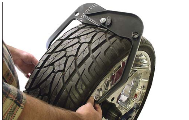
图 19 - 卡钳放置在车轮上
