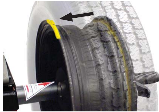
图 24 - 位于正上方处内侧凸缘的校准平衡块
