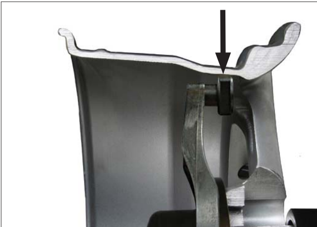
图 9 - 在用于说明的横断面轮辋上查看的隐藏式平衡块位置
