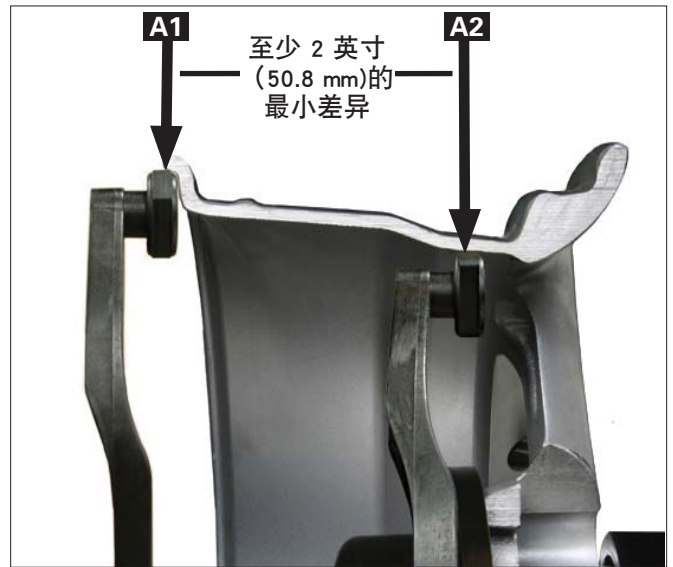
图 10 - T2 粘贴（隐藏式 Tape-A-Weight®）请保留 A1 与 A2 测量值之间相差至少 2 英寸（50.8 mm）
