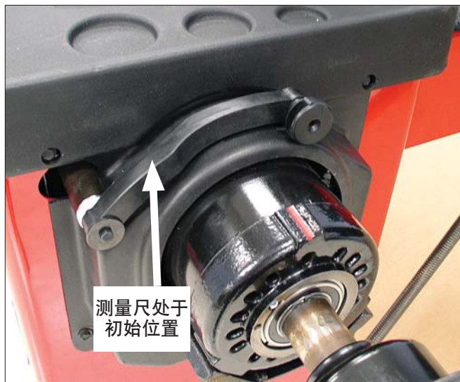
图 6 - 测量尺的位置（图示在初始位置）
