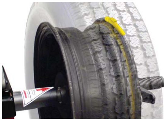
图 23 - 位于正上方处外侧凸缘的校准平衡块
