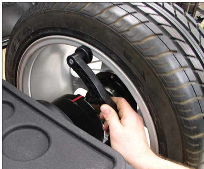
图 7 - 在卡钩式平衡块位置自动测量 A 与 D
