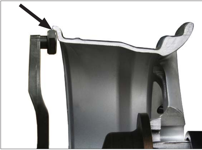
图 8 - 测量尺放置剖面图 - 卡钩式平衡块位置
