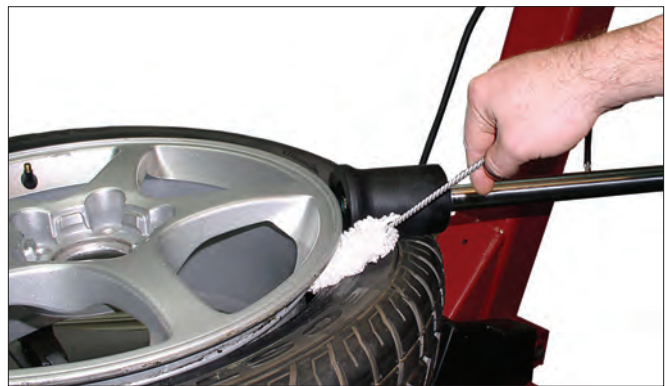
图10 - 给胎圈涂抹橡胶润滑油
