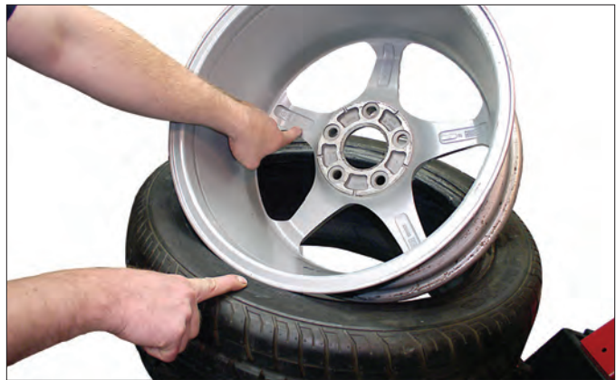
图 16 - 核实轮胎和车轮的尺寸是否相匹配
