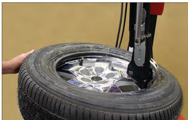
图 32 - 钩在下侧胎圈下方的胎圈升降工具
