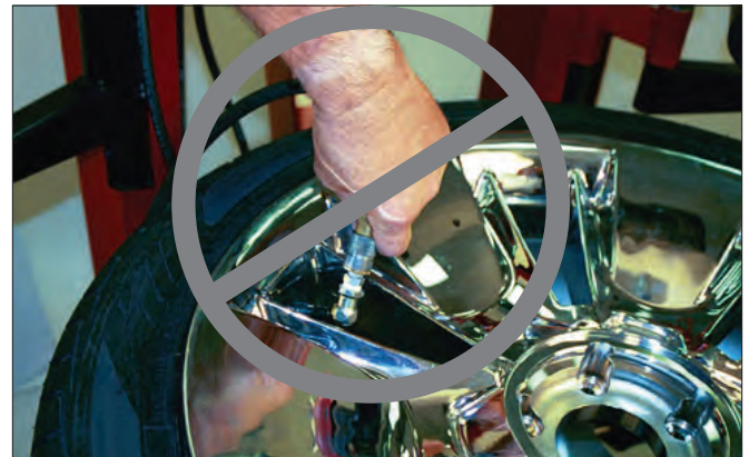
图 27 - 切勿使用手持型充气夹头
