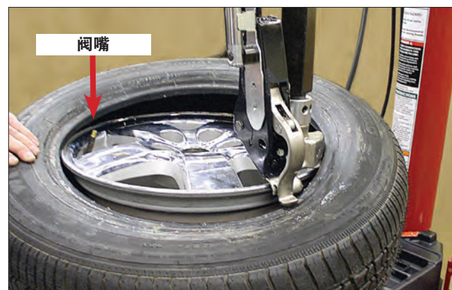
图 35 - 将阀嘴定位在胎圈锁前方
