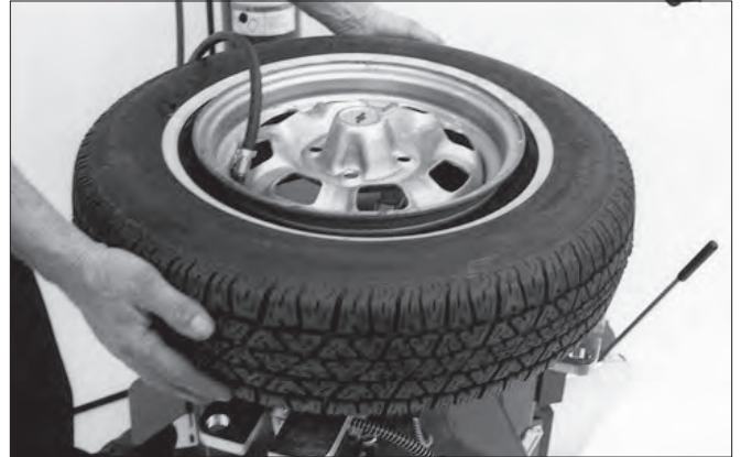
图 24 - 把轮胎向上托住进行胎圈爆充
