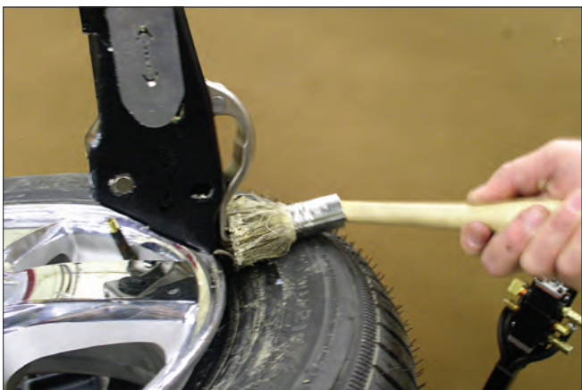
图 28 - 将润滑剂涂抹至胎圈升降工具
