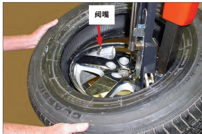
图 34 - 紧靠胎圈升降工具对轮胎进行定位
