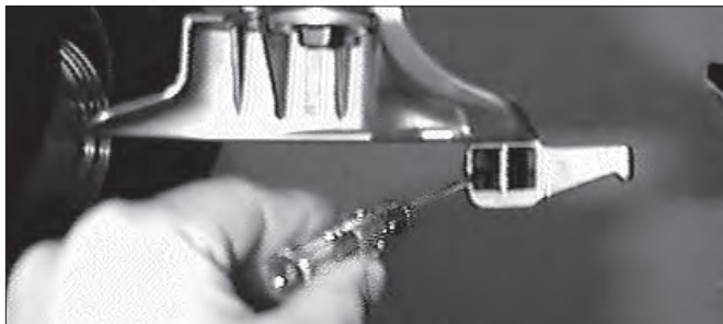
图 39 - 用小型螺丝刀清洁安装 / 卸载工具
