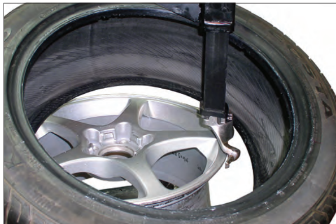
图 19 - 紧靠安装/拆卸工具对轮胎进行定位
