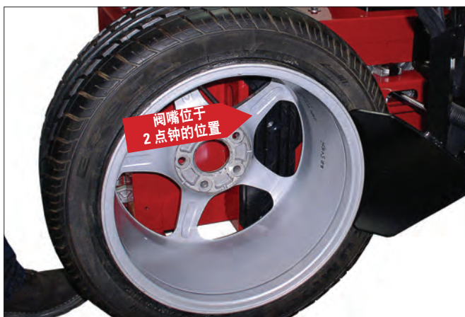
图 4 - 轮胎定位与松动胎圈大铲的定位，车轮调转至另一侧以及阀嘴处于 2 点钟的位置。
