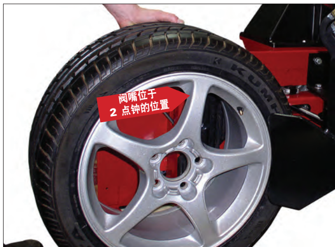
图 3 - 轮胎定位与松动胎圈大铲的定位，使阀嘴处于 2 点钟的位置。
