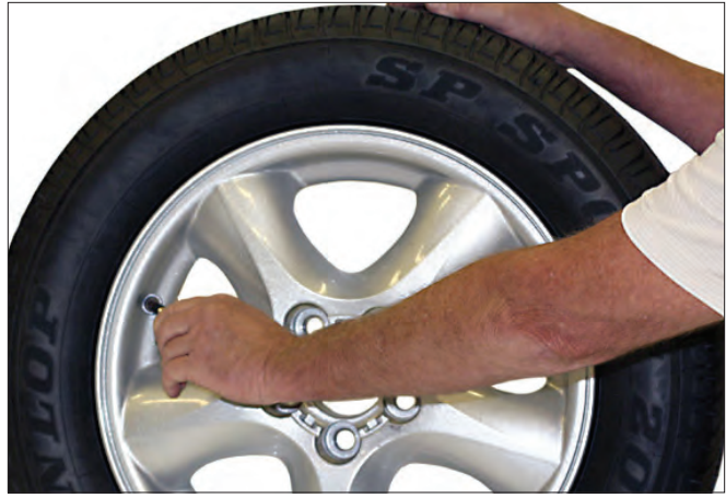
图 1 - 去除气门芯，使轮胎放气
