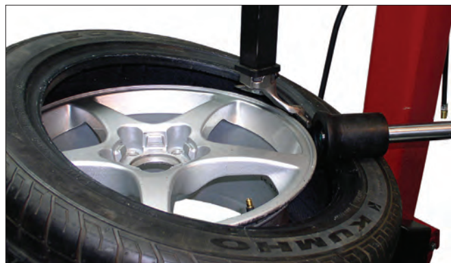
图 21a - 用电动滚筒将轮胎固定在轮辋的凹槽部分
