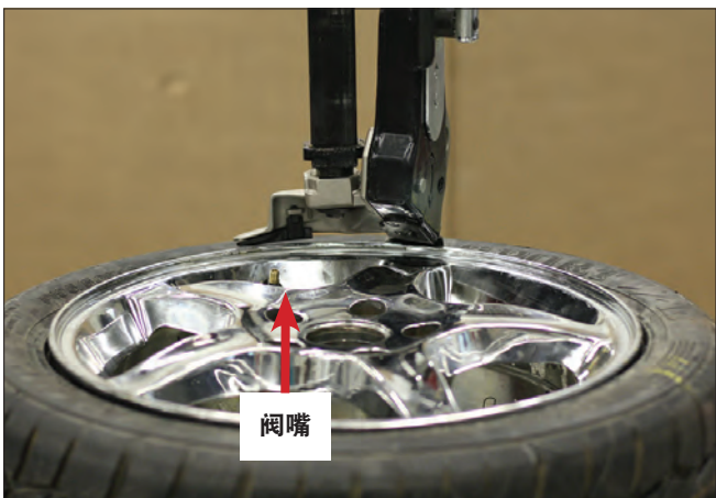
图 29 - 使用胎圈升降工具定位阀嘴
