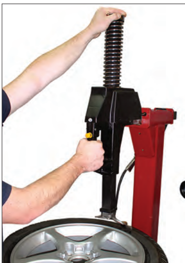
图9 - 定位安装/卸载工具
