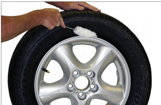
图 5 - 给胎圈涂抹橡胶润滑油
