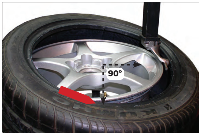
图 21 - 将阀嘴定位在安装工具前方 90 度角的位置上
