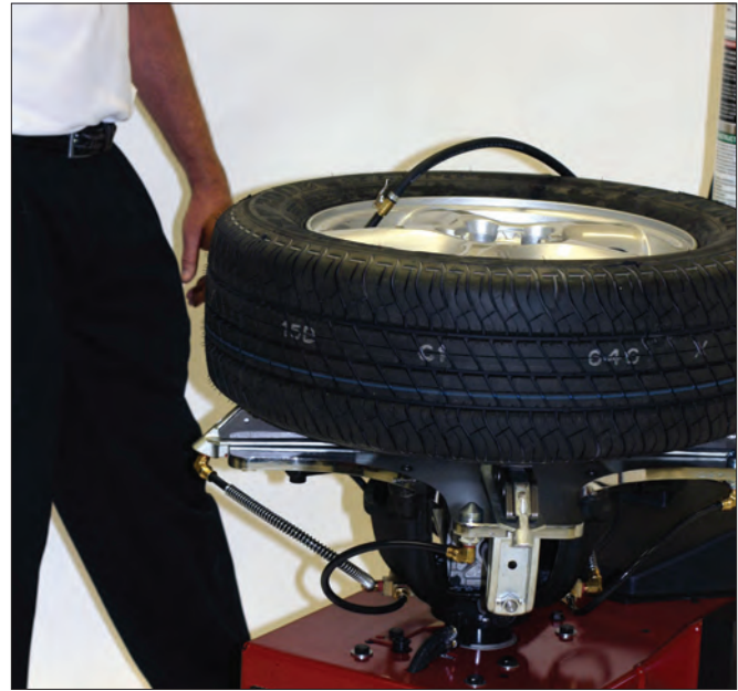
图 25 - 在胎圈就位期间，远离机器
