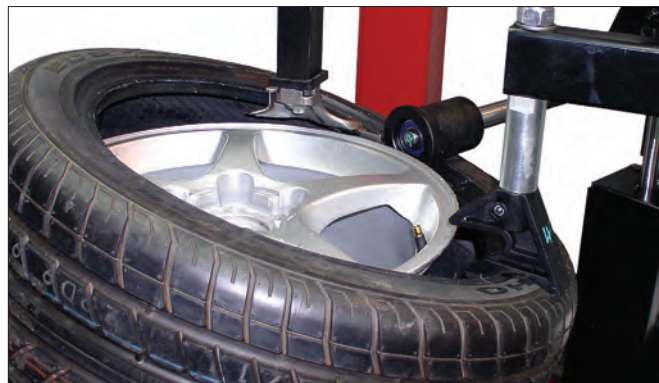
图 22 - 用机械辅助臂将轮胎固定在轮辋的凹槽部分
