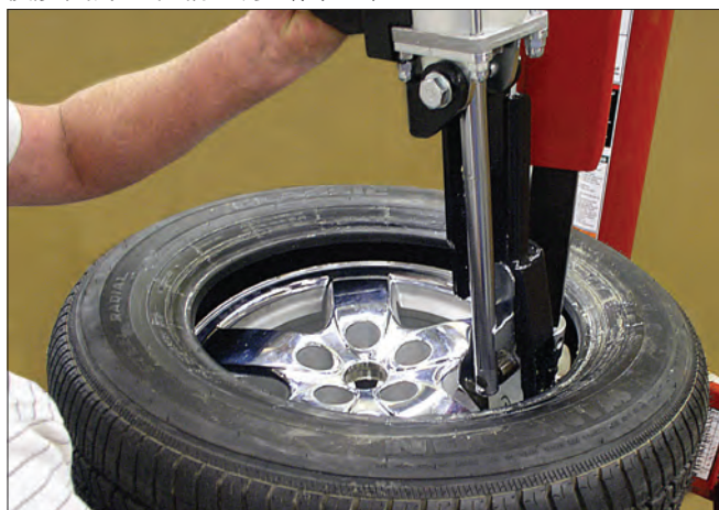
图 33 - 向上推动控制手柄使胎圈升至轮辋上方
