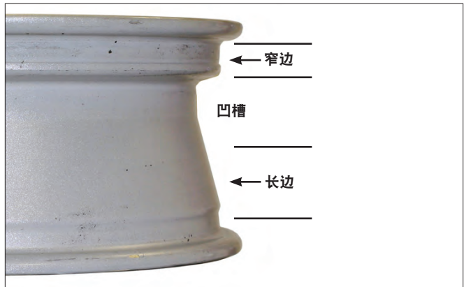
图 2 - 确定车轮的窄边
