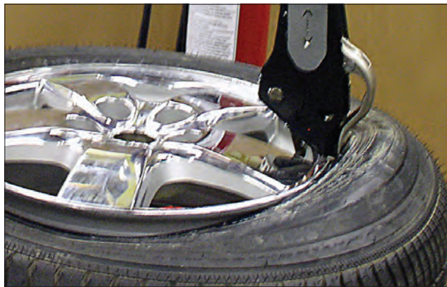
图 30 - 位于上侧胎圈下方的免撬棒胎圈升降工具
