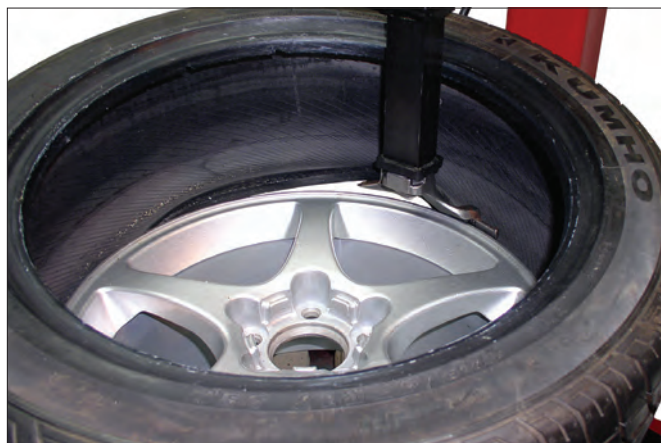
图 20 - 安装下侧胎圈
