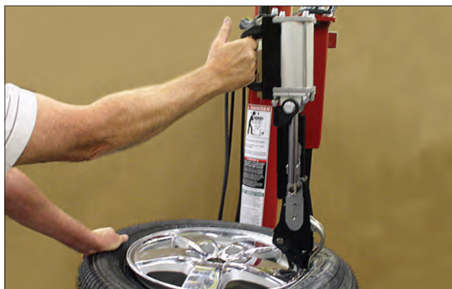
图 31 - 钩在胎圈下方的免撬棒工具
