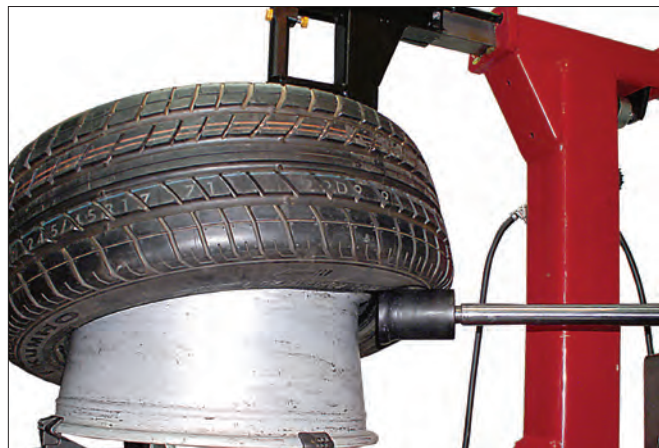
图 13 - 放置下方水平电动滚筒
